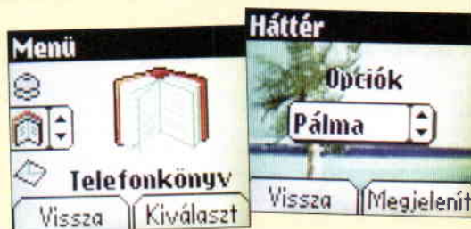
Kijelző. Az X3-2 kijelző csupán 101x80 pixel felbontású, viszont 4096 színt jelenít meg.
